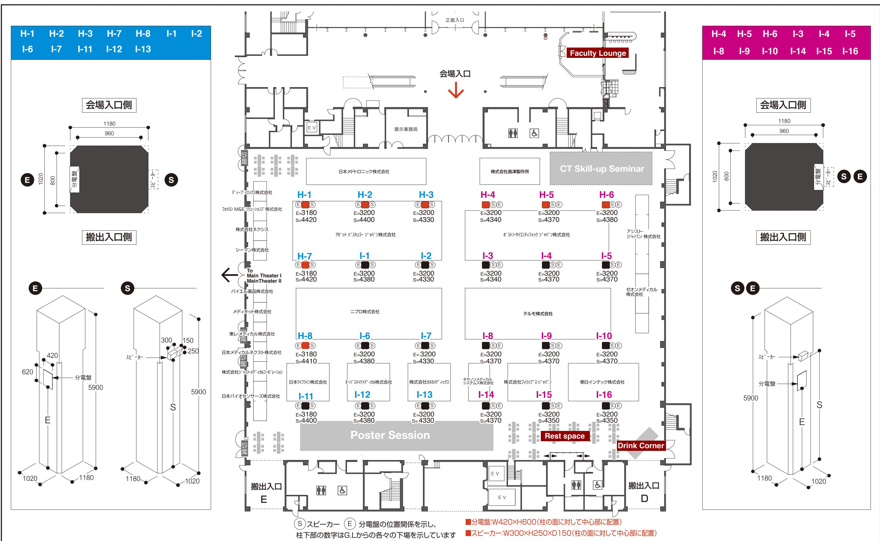
柱広告の設置位置の注意事項について..... 柱の4面ある1面に、電源取出分電盤・スピーカーがあります。電源を取るためだけでなく安全のためにも、この電源取出分電盤・スピーカーには広告パネル等が被らないよう設置のほどお願い申し上げます。尚、柱の電源取出分電盤のある面につきましては、上記図にてご確認ください。 また、柱広告の高さ制限を5m、通路側への厚みは20cm以下としてください。
