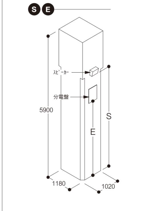
●分電盤:W420×H600(柱の面に対して中心部に配置)
